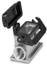
Custodia a zoccolo B16, con blocc. longitudinale, materiale: Pressofuso di alluminio, impermeabile, materiale coperchio: PC, uscite cavi: 2, laterali, 2x Pg21, altezza: 68 mm, connessione a vite per cavo: senza, coperchio di protezione: sì, Standard
