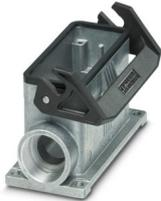
Custodia a zoccolo B16, con blocc. longitudinale, materiale: Pressofuso di alluminio, impermeabile, uscite cavi: 2, laterali, 2x M32, altezza: 68 mm, connessione a vite per cavo: senza, Standard
