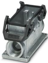
Custodia a zoccolo B16, con blocc. trasversale, materiale: Pressofuso di alluminio, impermeabile, uscite cavi: 2, laterali, 2x Pg21, altezza: 68 mm, connessione a vite per cavo: senza, Standard
