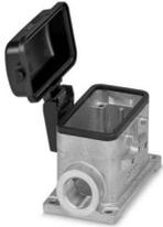
Custodia a zoccolo B10, per bloccaggio trasversale, materiale: Pressofuso di alluminio, impermeabile, materiale coperchio: PC, uscite cavi: 2, laterali, 2x M20, altezza: 54 mm, connessione a vite per cavo: senza, coperchio di protezione: sì, Standard
