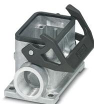
Custodia a zoccolo B6, con blocc. longitudinale, materiale: Pressofuso di alluminio, impermeabile, uscite cavi: 2, laterali, 2x M20, altezza: 54,6 mm, connessione a vite per cavo: senza, Standard
