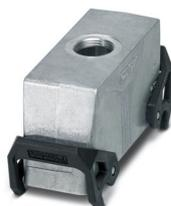
Custodia protettiva B24, con blocc. trasversale, materiale: Pressofuso di alluminio, impermeabile, uscite cavi: 1, diritto, 1x M25, altezza: 60 mm, connessione a vite per cavo: senza, Standard
