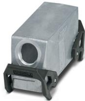
Custodia protettiva B24, con blocc. trasversale, materiale: Pressofuso di alluminio, impermeabile, uscite cavi: 1, laterali, 1x M32, altezza: 60 mm, connessione a vite per cavo: senza, Standard
