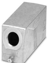
Custodia protettiva B24, per bloccaggio longitudinale, materiale: Pressofuso di alluminio, impermeabile, uscite cavi: 1, laterali, 1x Pg16, altezza: 60 mm, connessione a vite per cavo: senza, Standard
