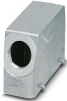
Custodia protettiva B24, per bloccaggio trasversale, materiale: Pressofuso di alluminio, impermeabile, uscite cavi: 1, laterali, 1x M32, altezza: 76 mm, connessione a vite per cavo: senza, Standard
