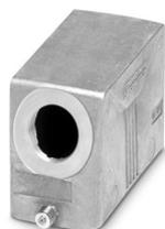
Custodia protettiva B16, per bloccaggio longitudinale, materiale: Pressofuso di alluminio, impermeabile, uscite cavi: 1, laterali, 1x Pg16, altezza: 60 mm, connessione a vite per cavo: senza, Standard
