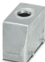
Custodia protettiva B16, per bloccaggio trasversale, materiale: Pressofuso di alluminio, impermeabile, uscite cavi: 1, diritto, 1x M25, altezza: 60 mm, connessione a vite per cavo: senza, Standard
