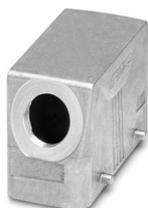
Custodia protettiva B16, per bloccaggio trasversale, materiale: Pressofuso di alluminio, impermeabile, uscite cavi: 1, laterali, 1x Pg21, altezza: 60 mm, connessione a vite per cavo: senza, Standard
