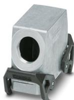
Custodia protettiva B16, con blocc. trasversale, materiale: Pressofuso di alluminio, impermeabile, uscite cavi: 1, laterali, 1x Pg29, altezza: 76 mm, connessione a vite per cavo: senza, Standard
