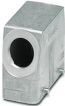
Custodia protettiva B16, per bloccaggio trasversale, materiale: Pressofuso di alluminio, impermeabile, uscite cavi: 1, laterali, 1x Pg29, altezza: 76 mm, connessione a vite per cavo: senza, Standard
