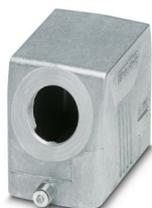
Custodia protettiva B10, per bloccaggio longitudinale, materiale: Pressofuso di alluminio, impermeabile, uscite cavi: 1, laterali, 1x Pg21, altezza: 57 mm, connessione a vite per cavo: senza, Standard
