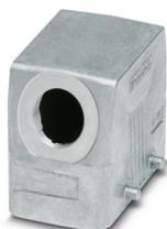
Custodia protettiva B10, per bloccaggio trasversale, materiale: Pressofuso di alluminio, impermeabile, uscite cavi: 1, laterali, 1x Pg16, altezza: 57 mm, connessione a vite per cavo: senza, Standard
