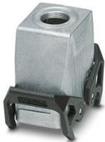
Custodia protettiva B10, con blocc. trasversale, materiale: Pressofuso di alluminio, impermeabile, uscite cavi: 1, diritto, 1x M25, altezza: 72 mm, connessione a vite per cavo: senza, Standard
