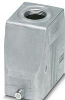
Custodia protettiva B10, per bloccaggio longitudinale, materiale: Pressofuso di alluminio, impermeabile, uscite cavi: 1, diritto, 1x Pg21, altezza: 72 mm, connessione a vite per cavo: senza, Standard
