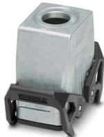
Custodia per giunti B10, con blocc. trasversale, materiale: Pressofuso di alluminio, impermeabile, uscite cavi: 1, diritto, 1x Pg29, altezza: 73 mm, connessione a vite per cavo: senza, Standard
