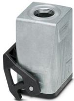
Custodia per giunti B6, con blocc. longitudinale, materiale: Pressofuso di alluminio, impermeabile, uscite cavi: 1, diritto, 1x M20, altezza: 73 mm, connessione a vite per cavo: senza, Standard
