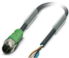
Cavo sensore/attuatore, 4-poli, PUR senza alogenati, grigio-nero RAL 7021, Maschio diritto M12 SPEEDCON, codifica: B, su estremità conduttore libera, lunghezza cavo: 2 m
