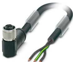
Cavo di alimentazione, 3-poli, PVC, nero, estremità conduttore libera, su Connettore femmina angolato M12, codifica: S, lunghezza cavo: 1 m, per corrente alternata fino a 16 A/690 V
