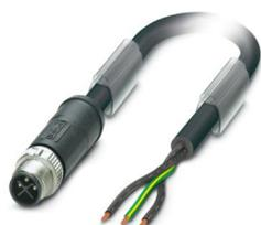
Cavo di alimentazione, 3-poli, PVC, nero, Maschio diritto M12, codifica: S, su estremità conduttore libera, lunghezza cavo: 5 m, per corrente alternata fino a 16 A/690 V
