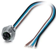
Connettore per apparecchi anteriore, Potenza, 4-poli, Femmina, diritto, M12-Standard, codifica: T, su estremità conduttore libera, Montaggio anteriore, M16 x 1,5, Fili singoli, lunghezza cavo: 0,5 m, 1,31 mm<sup>2</sup>, Filo per l'elettronica UL/cUL, saldato, Prodotto alternativo secondo RoHS II senza eccezione 6c (Pb < 0,1 %) cod. art.: 1238902
