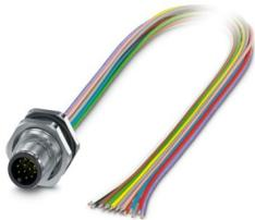
Connettore per apparecchi posteriore, Universale, 12-poli, Connettore, diritto, M12-Standard, codifica: A, su estremità conduttore libera, Montaggio posteriore, M16 x 1,5, Fili singoli, lunghezza cavo: 0,5 m, 0,14 mm<sup>2</sup>, Filo in TPE, saldato, Questo articolo è in continuo adattamento. Alternativa senza piombo secondo RoHS II senza eccezione 6c (Pb < 0,1%) possibile in anticipo su richiesta.
