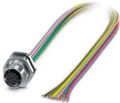
Connettore per apparecchi posteriore, Universale, 12-poli, Femmina, diritto, M12-Standard, codifica: A, su estremità conduttore libera, Montaggio posteriore, M16 x 1,5, Fili singoli, lunghezza cavo: 0,5 m, 0,14 mm<sup>2</sup>, Filo in TPE, saldato, Questo articolo è in continuo adattamento. Alternativa senza piombo secondo RoHS II senza eccezione 6c (Pb < 0,1%) possibile in anticipo su richiesta.
