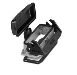
Custodia da incasso B24, con blocc. longitudinale, materiale: Pressofuso di alluminio, impermeabile, materiale coperchio: PC, altezza: 30,5 mm, connessione a vite per cavo: senza, coperchio di protezione: sì, Standard, con guarnizione piatta
