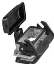
Custodia da incasso B16, con blocc. longitudinale, materiale: Pressofuso di alluminio, impermeabile, materiale coperchio: PC, altezza: 30,5 mm, connessione a vite per cavo: senza, coperchio di protezione: sì, Standard, con guarnizione piatta
