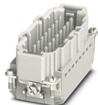
Inserto contatti, numero poli: 16+PE, dimensioni: B16, numero di connessioni per polo: 1, Spina, Connessione Push-in, 500 V, 16 A, 0,14 mm<sup>2</sup> ... 2,5 mm<sup>2</sup>, applicazione: Potenza
