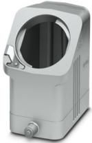
Custodia mobile HEAVYCON EVO, esecuzione EMC, senza verniciatura con polveri, con flangia a baionetta per la connessione EVO, B10, per bloccaggio longitudinale, altezza 80 mm, senza connessione EVO.
