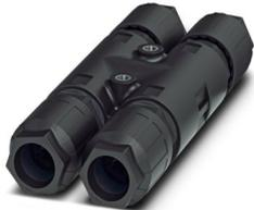
Distributore QUICKON H, nero, 4+PE poli, 2,5 mm<sup>2</sup> ... 6,0 mm<sup>2</sup> / 690 V / 40 A, per cavi di diametro 9 mm ... 14 mm, con un bullone di chiusura.
