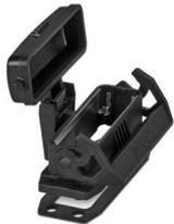
Custodia da incasso D25, con blocc. longitudinale, materiale: PA 6.6-FR, materiale coperchio: PC, altezza: 26 mm, connessione a vite per cavo: senza, coperchio di protezione: sì, Standard, con guarnizione piatta
