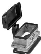
Custodia da incasso B16, per bloccaggio trasversale, materiale: Pressofuso di alluminio, impermeabile, materiale coperchio: PC, altezza: 30,5 mm, connessione a vite per cavo: senza, coperchio di protezione: sì, Standard, con guarnizione piatta
