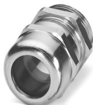
Pressacavi, materiale connessione a vite: Ottone, nichelato, applicazione: Standard, diametro esterno cavo 13 mm ... 18 mm, schermatura: no, filettatura: 3/4" NPT, colore: argento, con O-ring
