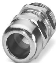
Pressacavi, materiale connessione a vite: Ottone, nichelato, applicazione: Standard, diametro esterno cavo 13 mm ... 18 mm, schermatura: no, filettatura: Pg21, colore: argento, con O-ring
