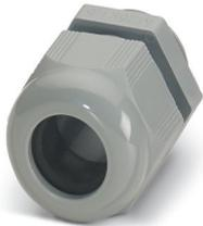
Pressacavi, materiale connessione a vite: PA, applicazione: Standard, diametro esterno cavo 10 mm ... 14 mm, schermatura: no, filettatura: 1/2" NPT, colore: grigio-argento RAL 7001
