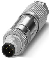
Connettore dati, PROFINET CAT5 (100 MBit/s), 4-poli, senza alogenati, schermata, Maschio diritto M12, codifica: D, Connessione a perforazione di isolante, materiale zigrinato: Pressogetto di zinco, nichelato, diametro esterno conduttore 5 mm ... 9,7 mm
