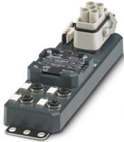
Distributore Power, applicazione: Alimentazione di energia, tipo di connessione: Connettore femmina M12 Metallo, numero degli slot: 4, numero poli: 4, codifica: T, occupazione slot: singolo, segnalazione di stato: sì, Universale; connessione linea principale: Connessione linea principale a innesto 90°, schermatura: no, Porta di diagnostica, M12, codifica A, numero di poli: 12
