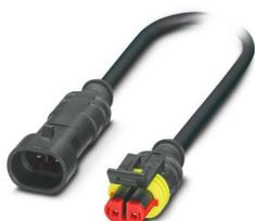
Cavo sensore/attuatore, 2-poli, PUR senza alogenati, grigio-nero RAL 7021, Maschio diritto Superseal Bloccaggio a clip, codifica: A, su Connettore femmina diritto Superseal Bloccaggio a clip, lunghezza cavo: 1,5 m
