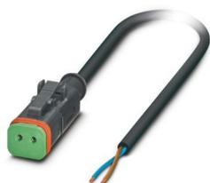
Cavo sensore/attuatore, 2-poli, PUR senza alogenati, grigio-nero RAL 7021, estremità conduttore libera, su Connettore femmina diritto DEUTSCH DT06-2S Bloccaggio a clip, codifica: A, con 1 LED , Circuito: Diodo, lunghezza cavo: 5 m
