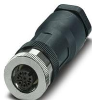
Connettore, Universale, 8-poli, Femmina diritto M12, codifica: A, Connessione a vite, materiale zigrinato: Ottone, nichelato, connessione a vite per cavo Pg11, diametro esterno conduttore 8 mm ... 10 mm
