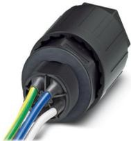
Passaparete QUICKON, 4+PE poli, 2,5 mm<sup>2</sup> ... 6,0 mm<sup>2</sup>/690 V/40 A, con dado QUICKON, nero, per diametro cavi 9 mm ... 14 mm, filettatura M25 con 5 fili di conduttore saldati da 6,0 mm<sup>2</sup>, lunghezza 1,0 m, tagliati a livello all'estremità.
