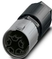
Connettore, product family: QPD, tipo di connessione: Connessione IDC, numero poli: 4+PE, 2,5 mm<sup>2</sup> ... 6 mm<sup>2</sup>, 690 V, 40 A, PA, nero, con dado QUICKON, diametro esterno conduttore: 12 mm ... 20 mm
