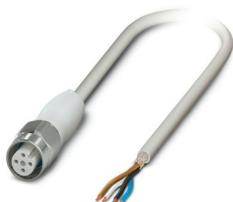
Cavo sensore/attuatore, 4-poli, PP-EPDM senza alogenati, grigio RAL 7035, schermata, estremità conduttore libera, su Connettore femmina diritto M12, codifica: A, lunghezza cavo: 20 m, Hygienic Design, con zigrinatura in acciaio inox
