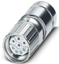
Connettore per cavi, diritto, corto, Bloccaggio a vite, M23, tipo di connessione del contatto: Femmina, schermata: sì, grado di protezione: IP67, diametro cavi: 11 mm ... 14 mm, numero poli: 8, tipo di connessione: Connessione a crimpare
