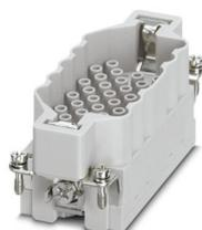
Inserto contatti, numero poli: 40+PE, dimensioni: B16, numero di connessioni per polo: 1, Spina, Connessione a crimpare, 500 V, 16 A, 0,5 mm<sup>2</sup> ... 4 mm<sup>2</sup>
