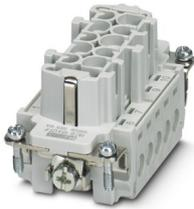
Inserto contatti, numero poli: 10+PE, dimensioni: B10, numero di connessioni per polo: 1, Femmina, Connessione a vite, 500 V, 16 A, 0,5 mm<sup>2</sup> ... 2,5 mm<sup>2</sup>, applicazione: Potenza
