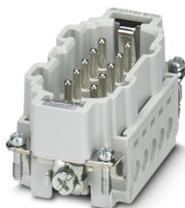
Inserto contatti, numero poli: 10+PE, dimensioni: B10, numero di connessioni per polo: 1, Spina, Connessione a vite, 500 V, 16 A, 0,5 mm<sup>2</sup> ... 2,5 mm<sup>2</sup>, applicazione: Potenza
