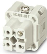
Inserto contatti, numero poli: 3+PE, dimensioni: D7, numero di connessioni per polo: 1, Femmina, Connessione a vite, 230 V/400 V, 10 A, 0,5 mm<sup>2</sup> ... 2,5 mm<sup>2</sup>
