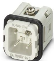
Inserto contatti, numero poli: 3+PE, dimensioni: D7, numero di connessioni per polo: 1, Spina, Connessione a vite, 230 V/400 V, 10 A, 0,5 mm<sup>2</sup> ... 2,5 mm<sup>2</sup>
