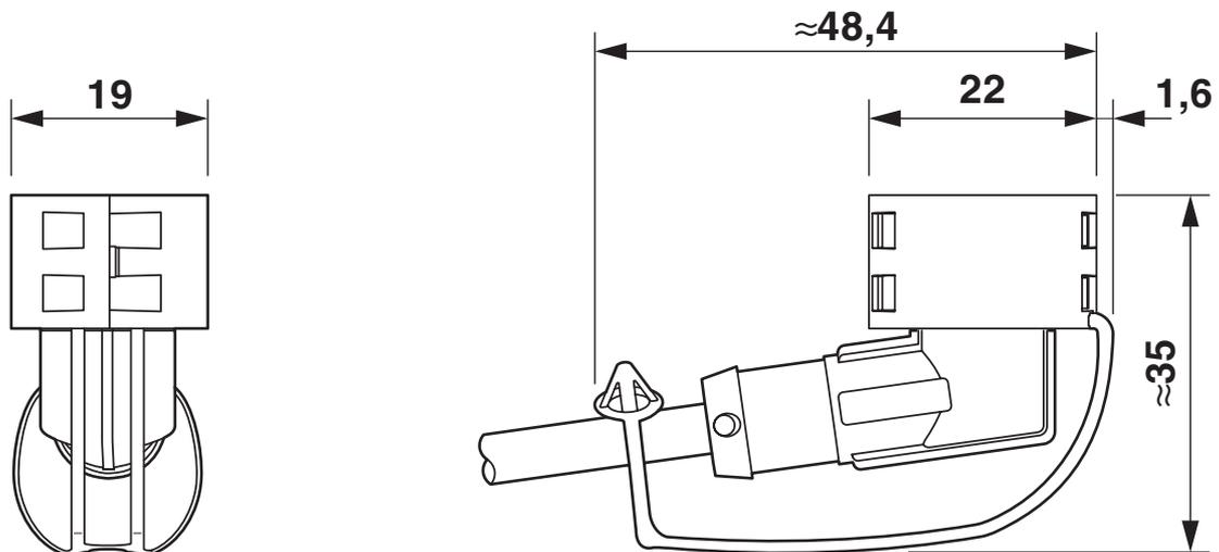
Connettore maschio montato con EXCLIP
