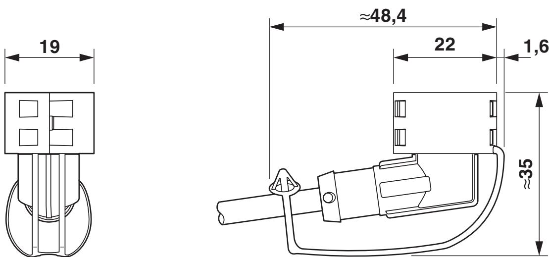
Connettore maschio montato con EXCLIP
