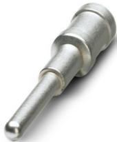
Contatto a crimpare, Serie di prodotti: PRC 35, sezione del conduttore max.: 4 mm<sup>2</sup>, tensione di dimensionamento: 690 V AC, corrente nominale: 32 A, Tipo di connessione: Connessione a crimpare, Tipo di connessione del contatto: Spina, Crimpare il conduttore conformemente alla norma DIN EN 60352-2 con il contatto a crimpare
